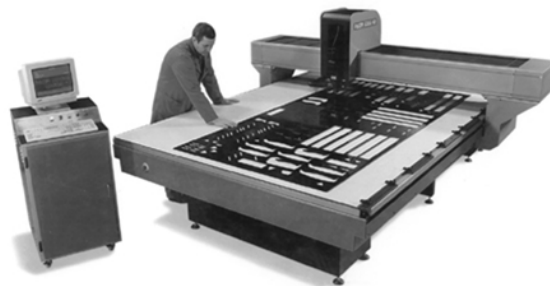
Figure 6 Défonçeuse Gerber fournie par Spandex plc.
