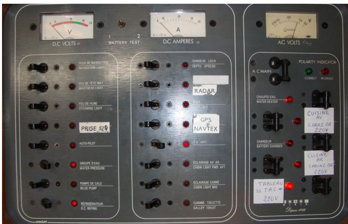
12V : Feux de navigation – prises 12V -pilote automatique - groupe eau douce - pompe de calle - frigo
