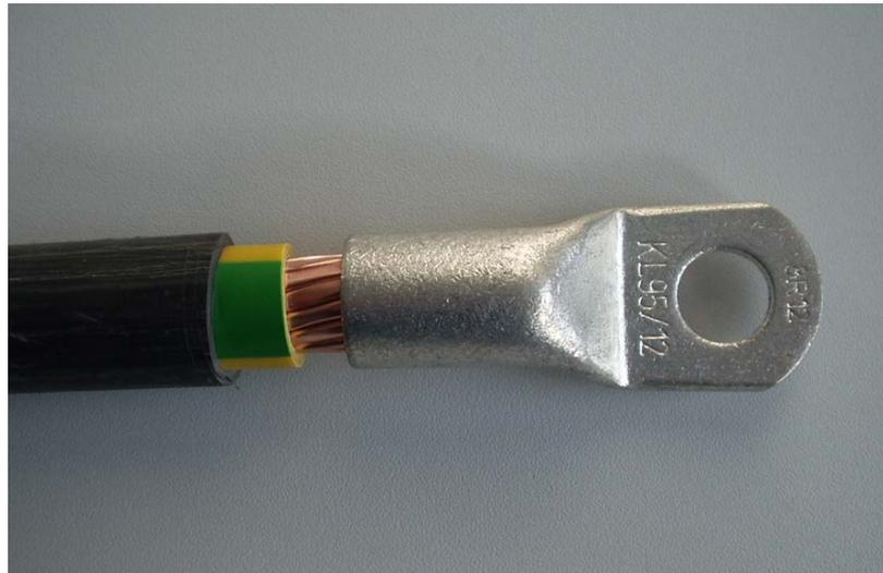
... le conducteur de 120 mm<sup>2</sup> convient certes à une cosse de 95 mm<sup>2</sup>, mais il ne présente plus la section adéquate (intensité maximale admissible) !
