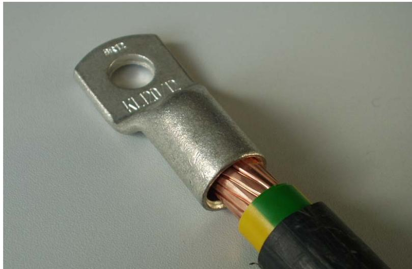
... mais le conducteur de 120 mm<sup>2</sup> ne convient plus de façon optimale à la cosse de 120 mm<sup>2</sup> .
