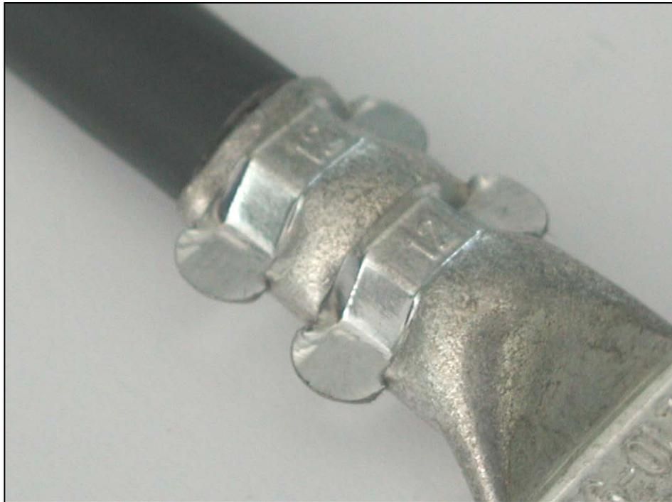
**Sertissage excessif du raccord**
