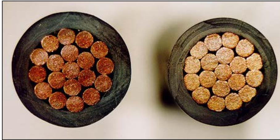
Le diamètre d'un conducteur comprimé équivaut en moyenne à 86 % et 94 % du diamètre d'un conducteur non comprimé de section identique.
